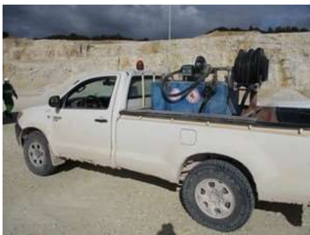
Photo 5 : Véhicule aménagé pour la distribution de carburant
